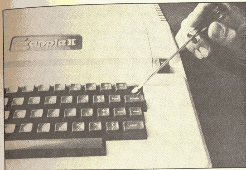
Fig. 2.10. — Pour vous protéger d'un RESET accidentel : phase 2.
